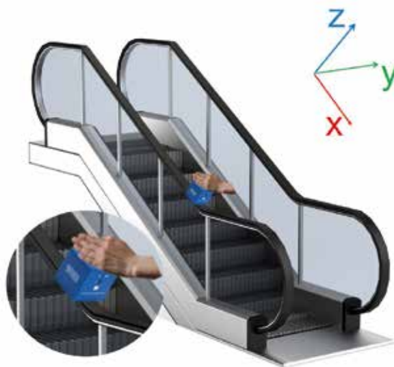
Ausrichtung und Positionierung des Vibrationssensors auf den Handläufen der Fahrtreppe / Orientation and positioning of the vibration sensors on the handrails of the escalator
