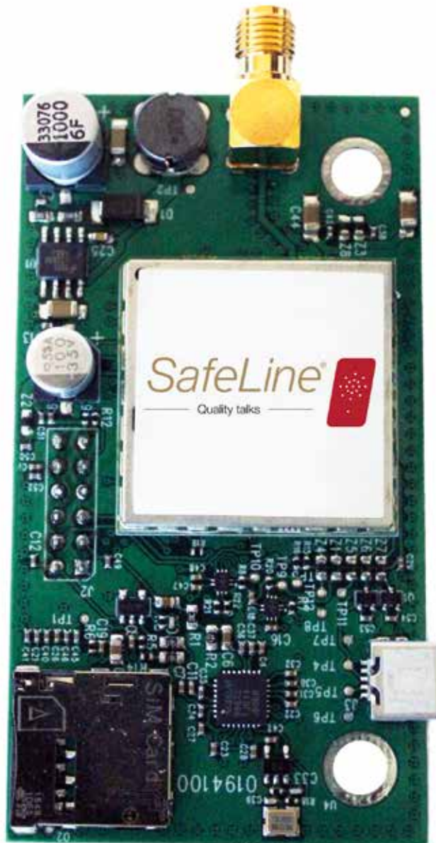
Das GSM-Modul für die Zukunft; gleichzeitige Unterstützung für 2G, 3G und 4G-Netze / The GSM module for the future; simultaneous support for 2G, 3G and 4G networks
