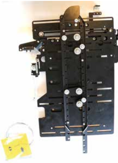
Spreizkuppler mit Fahrkorb­türverriegelung Expanding coupler with lift car door lock
