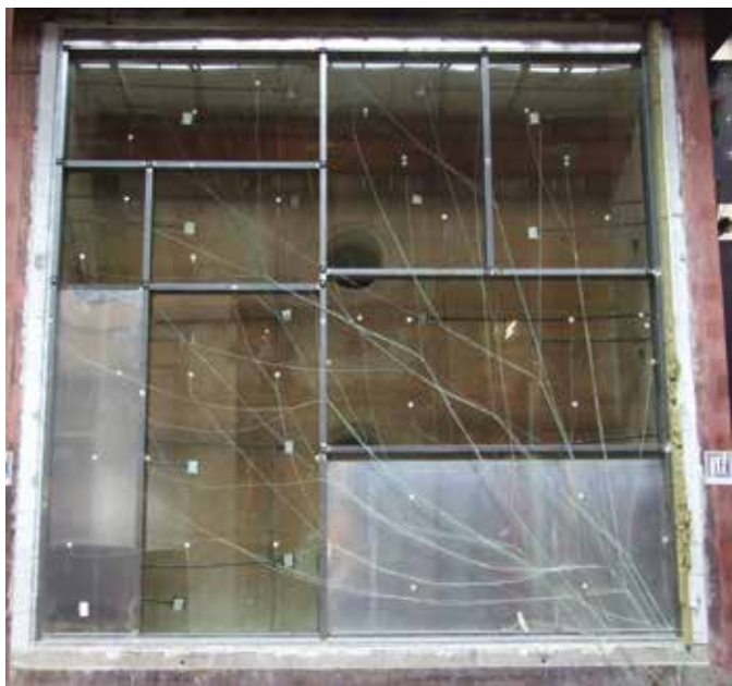
Brandschutzprüfung einer „geraden“ Fassade.
