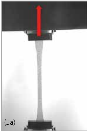
Abbildung: Untersuchung des thermo-viskoelastischen Materialverhaltens (3a): Konventioneller Relaxationsversuch innerhalb einer Klimakammer im uniaxialen Zugmodus (3b): DMTA an einem Torsionsstreifen.
