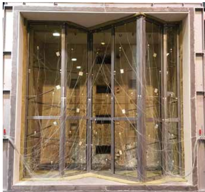
Brandschutzprüfung einer Fassade mit Eckausbildung.
