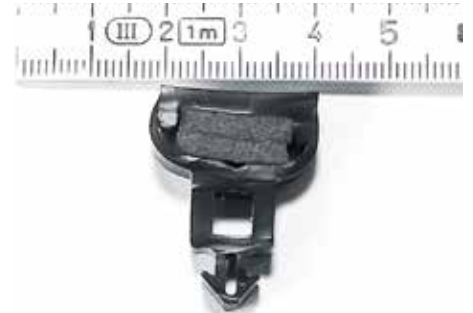
Entnommenes Silikonprofil bestehend aus – von unten nach oben – Trägerprofil Silikon, Schaumstoffprofil mit Hohlräumen.
