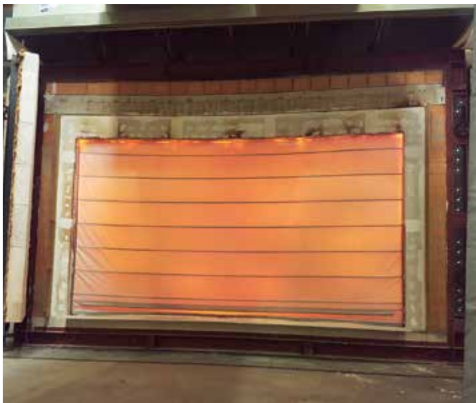
Brandschutzvorhang der KGG Brandschutzsysteme GmbH auf dem 8 x 5 m Brandofen des ift Rosenheim.
