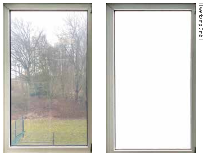
Folie geschaltet (links) und ausgeschaltet (guter Sichtschutz).
