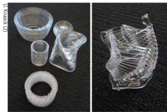
Abbildung 2: Additiv hergestellte Glaskulpturen vom MIT.
