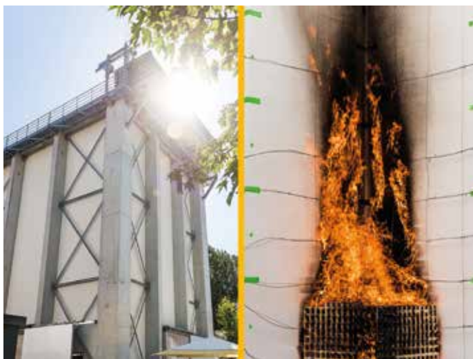
An dem neuen Fassadenprüfstand werden Brandtests zur Prüfung und Zertifizierung von Fassaden, Glasfassaden, Komponenten- oder Integralfassaden durchgeführt.
