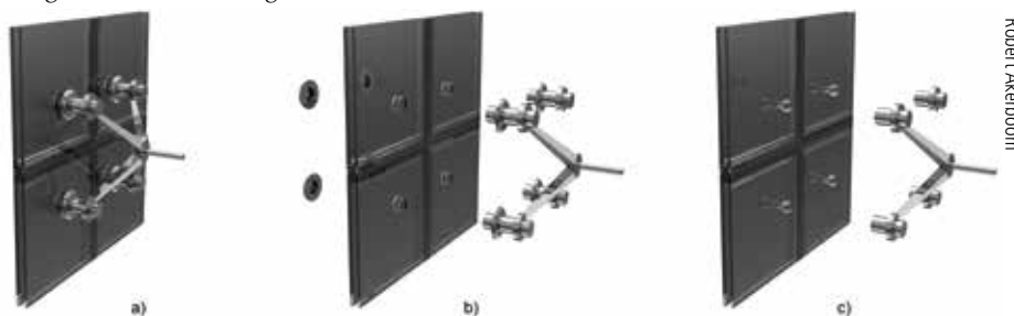
Abbildung 1: Spider in einer Glasfassade a) Montierte Ansicht, b) Explosionsansicht und c) Vorgeschlagenes System.
