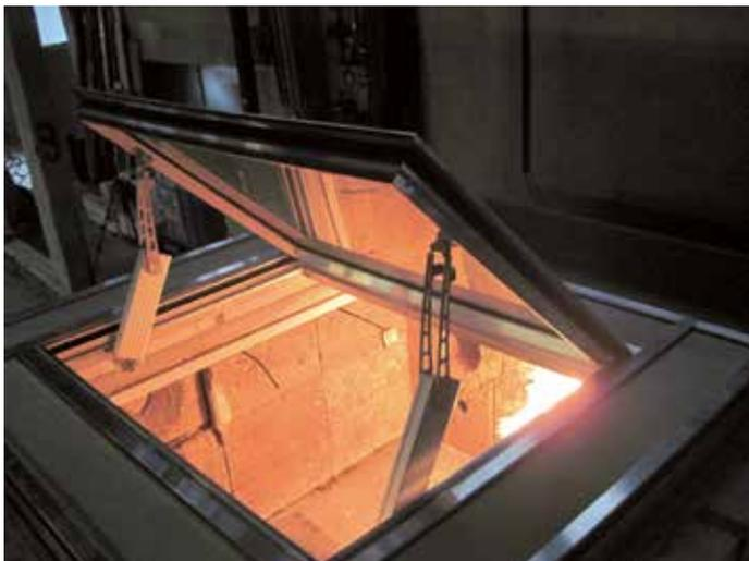
Nach der Prüfung (Brandfall) wird überprüft, ob das NRWG vollständig geöffnet hat.
