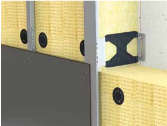
Bild 3 – „wärmebrückenfreie“ Wandhalter FOX-T mit Kunststoffsteg von Hilti.
