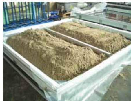
Versuche zur Belastbarkeit der Scheiben mit Sand.
