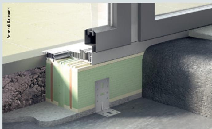
o. Ralmo-ABE vereinfacht die Montage, sichert eine zuverlässige Lastabtragung und sorgt für eine sehr gute Wärmedämmung am unteren Bauanschluss. u.l. Auf Wunsch fräst Ralmont das ABE-Element exakt passend zur jeweiligen Bodenschiene. Passende Abdichtungsfolien gibt es ebenfalls bei Ralmont. u.r. Mit dem Ralmo-ABE Stellfuß lässt sich die Aufdopplung perfekt positionieren. Zusätzliche Winkel sind nicht erforderlich.
