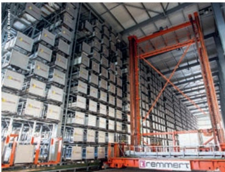
Vollautomatisch wird das Material mit dem Regalbediengerät (RBG) von den 650 Lagerplätzen zur passenden Auslagerstation gebracht.
