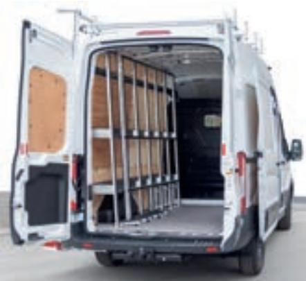
o.: Hegla Innenreff mit zweiteilig klappbarer Auflage. Je nach Bedarf und ganz flexibel kann der Innenraum fast über die gesamte Breite genutzt werden.
